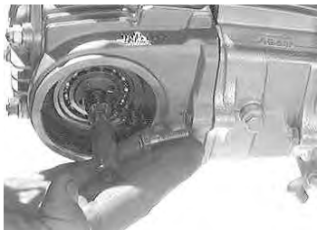
ヘッドサイドボルトを取り付ける。先に仮止めしていたガイドローラーボルトとシリンダーサイドボルトを締め付ける。
