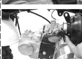
インレットパイプをシリンダーヘッドに止めているボルト2本を取り外しインレットパイプ、キャブレター、エアクリナーを取り外す。
