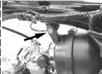
エアクリナーステー部のボルトを取り外す。 使用工具 ボックスレンチ 10mm エクステンションバー 小
