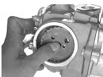
ここは難易度が高いです。がんばって下さい。 カムスプロケットをはめたあとはボルトを取り付ける。カムチェーンにカムスプロケットをかけたがらカムスプロケットのOマークとシリンダーヘッドの切り欠き部が合うようにカムチェーンをはめてカムシャフトに取り付ける。
