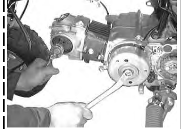
カムシャフトワッシャを取り付けます。 フライホイールを固定してカムスプロケットボルトを3本締め付ける。
