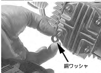
ヘッドカバーのワッシャとナットを取り付ける。 (エンジンを前から見て左下が銅ワッシャ残りの3つは鉄ワッシャ、右下が六角ナット残りの3つがぶくるナット)
