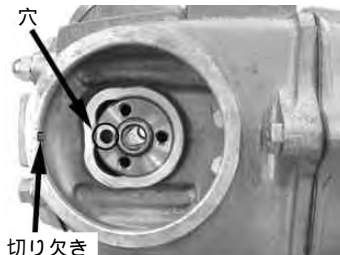
切り欠き カムシャフトの穴をシリンダーヘッドの切り欠き方向に向ける。それがカムシャフトの圧縮上死点です。 オプションカム取り付けの場合、オプションカムの説明書の指示に従って下さい。
