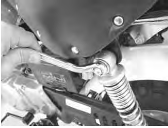
リアショックのナット2個を緩める。 使用工具 オフセットレンチ 14mm
