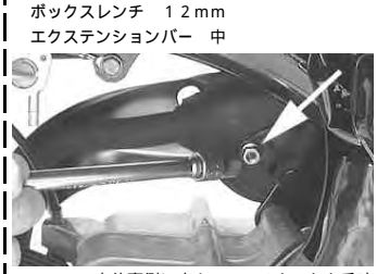
マフラー本体裏側に止まっているナットを反時計方向に回し取り外す。
