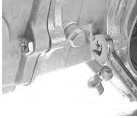
締め付けトルク ガイドローラーボルト 10 N・m (1.0 kgf・m) サイドボルト上下 10 N・m (1.0 kgf・m)
