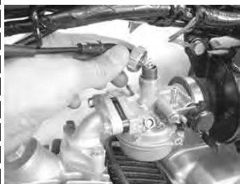
キャブレターのトップキャップを外し、スロットバルブをキャブレターから抜き取る。
