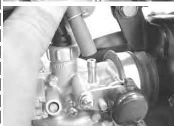
チューブクリップをずらし、キャブレターのフューエルチューブの接続を外す。
