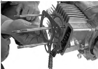
ヘッドガスケットを取り付ける。
