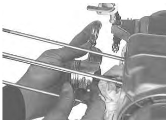
ピストンピンをピストンサークリップが付いていない方向へ取り外す。ピストンサークリップの付いている方向からマイナスドライバーで押してあげると簡単にとれます。
