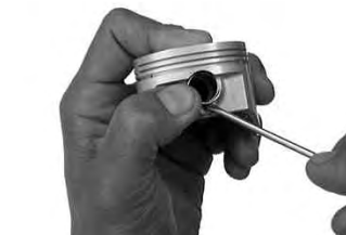
ピストンの片側に付属のピストンピンサークリップをサークリップ溝にきっちりはめ込む。この時、サークリップの合い口は切り欠き部を避けて取り付けて下さい。
