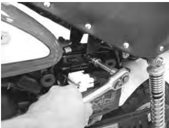
シート下のナットを緩め、ボルトを取り外す。 使用工具 ボックスレンチ 12mm エクステンションバー 小 オフセットレンチ 10mm
