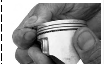
下オイルリングサイドレールを入れる。
