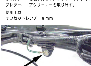
インレットパイプをシリンダーヘッドにとめているボルト2本を取り外しインレットパイプ、キャブレター、エアクリーナーを取り外す。 使用工具 オフセットレンチ 8mm
