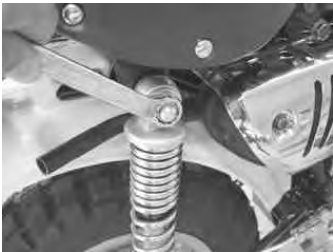
シート下のナットを緩め、ボルトを取り外す。 使用工具 ボックスレンチ 12mm エクステンションバー 小 オフセットレンチ 10mm
