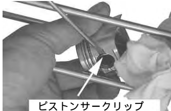
ピストンサークリップの片側を取り外す。ピストンピン穴の切り欠き部を利用してこじるようにすると外れます。
