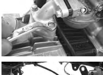
マフラー本体を止めている六角ボルトを反時計方向に回し取り外す。 使用工具 ボックスレンチ 12mm エクステンションバー 中
