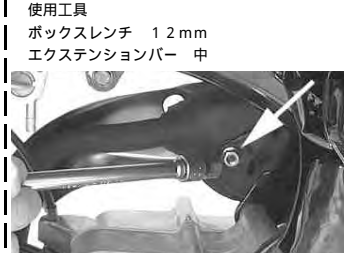
マフラー本体裏側に止まっているナットを反時計方向に回し取り外す。 使用工具 ボックスレンチ 10mm エクステンションバー 中
