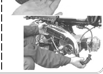
アース線をエアクリーナーステー部のボルトでフレームに取り付ける。 使用工具 ボックスレンチ 10mm エクステンションバー 小 規定トルク 1.2N・m(1.2kgf・m)
