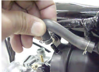
ストレージタンクのホース(フレームNo AB 27-の車両の場合)を抜き取る。
