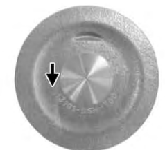
ドライバーでピストンにキズを付けないように押し込むと比較的簡単に取り付けられます。ピストンサークリップは左側を先にはめ込みます。
