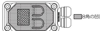
パネルは8角の凹面内に正確に貼り付けて下さい。すべて端部にパネルが乗り上げてしまうと、接着不具合によりその隙間から雨水等が内部に浸入し、故障てしまいます。パネルは枠のサイズよりも若干小さく製作しています。
