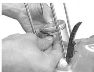
c. ピストンリングにエンジンオイルを塗布して、各リングが、滑らかに回転することを確認して下さい。ピストンリングの合い口は、ピストンリング方向とその直角方向を避け、120度間隔にして下さい（上図参照）。
