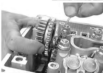
f. シリンダーヘッドマウントソケットボルト2本を取り外します。シリンダーヘッドフランジナット4個を対角に2~3回に分けてゆるめて、フランジナット、シーリングワッシャを外し、シリンダーヘッドを取り外します。
