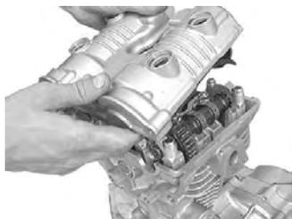
b. クランクシャフトを反時計方向に回し、カムシャフトのスリッパ部がバルブリフターを押ししていない状態で、フライホイールの“T”マークをL. クランクケースの合わせマークに合わせます。
