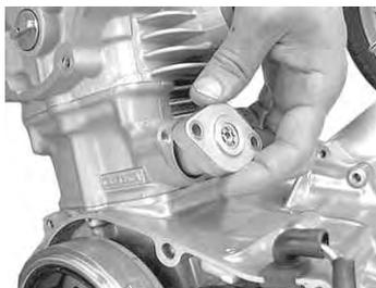
e. アイドルギアシャフトのソケットボルトを外し、アイドルギアシャフトを取り外します。カムチェーンからアイドルギアを取り外します。この時、カムチェーンがクランクケース内に落ちないように針金などでつっておいて下さい。
