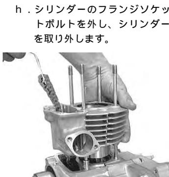
h. シリンダーのフランジソケットボルトを外し、シリンダーを取り外します。
