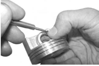
ピストンピンサークリップの合口は切り欠き部を避けて取り付けること。
