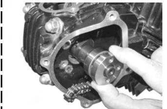
ロッカーアームを手で持ち、ロッカーアームシャフトをシリンダヘッドに差し込み、取り付ける。
