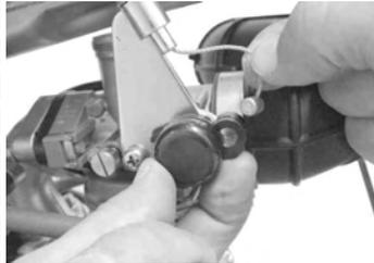
クランプを取り外す。チューブクランプを取り外し、フューエルホースの接続を外す。エアクリーナダクトのクランプスクリーンを緩める。
