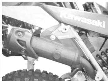
ナット2個とボルト2本を締め付ける。
