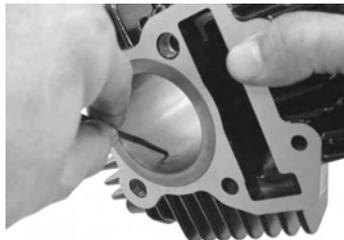
シリンダをピストンリングの合口の位置がずれないように指で少しずつピストンにはめていき、シリンダをクランクケースにはめ込む。シリンダがピストンにはまったら、カムチェーンをシリンダに通しておく。
