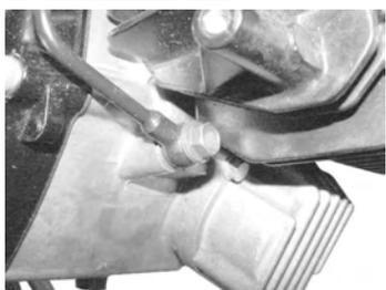
ヘッドボルト2本を取り外す。ヘッドナット4個を対角に数回に分けてゆるめ、取り外す。
