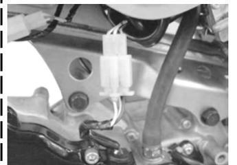
ボルト9本を取り外し、ジェネレーターカバーを取り外す。ロックピンは再使用するので取り外しておく。
