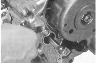
カムチェーンをカムスプロケットに取り付け、キット内のカムギアワッシャとシリンダーヘッドキット内のキャップスクリューM5×12（黒色）2本を用いて取り付けます。
