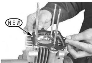
使用するシリンダーヘッドガスケットに注意して下さい。
