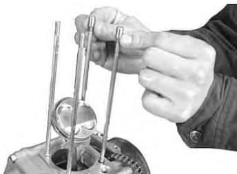
クランクケースのシリンダーベース面にキット内の部品のシリンダーガスケットを取り付けます。
