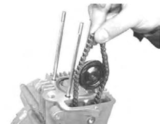
カムチェーンガイドローラーをガイドローラーピンにシーリングワッシャを取り付け仮締めします。
