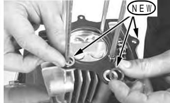
使用するシリンダーヘッドガスケットに注意して下さい。
