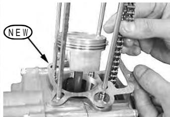
クランクケースのシリンダーベース面のオイルリターン穴部にキット内の新品のラバーパッキン（ブラック）を取り付けます。
