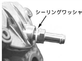
カムチェーンテンショナー部のサイドボルトを締め付けます。
