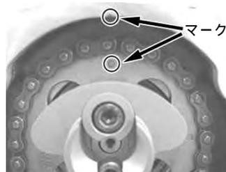
クランクを固定し、カムスプロケットを固定しているキャップスクリューを規定トルクまで締め付けます。
