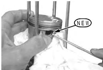
詰めていたウエスを取り外します。クランクケースのシリンダーベース面をきれいに脱脂し、ノックピン穴に、ノックピン 8 × 1.2 を取り付けます。
