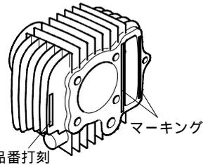
品番やマーキングが無いシリンダー、シリンダーキット内にラバーガスケット(緑)が付属しているシリンダーにはシリンダーヘッドガスケット(厚み1.0mm 3枚重ねの物) ラバーパッキン(黒) ラバーガスケット(緑)を取り付けます。
