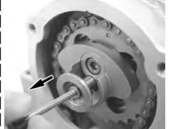
アジャストナットを規定トルクまで締め付けます。
