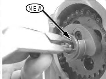
アジャストスクリューでバルブクリアランスを調整します。
