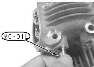
シリンダーにキット内の8×14のノックピンをノックピン穴にセットします。
