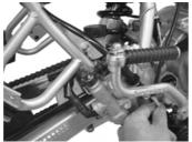
2.マッドガード(アルミ)を上下裏表に注意してフレームに合わせ、 キット内のタイラップで、マッドガード (アルミ)をフレームに固定 します。
