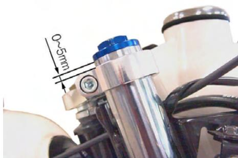
トップブリッジの割り締めボルトを指定トルクで締め付けます。
