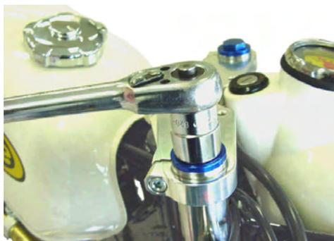
ヘッドライトブラケットを付属のソケットキャップスクリュー(10×10)とプレーンワッシャ(10mm)でトップブリッジに仮締めします。
