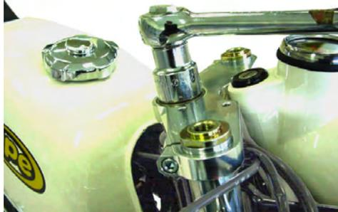
ノーマルのフォークボルトを取り外し、付属のフォークトップボルトにOリングを付け、インナーチューブに取り付けます。フォークトップボルトを規定トルクで締め付けます。トルク:23N・m(2.3kgf・m)
