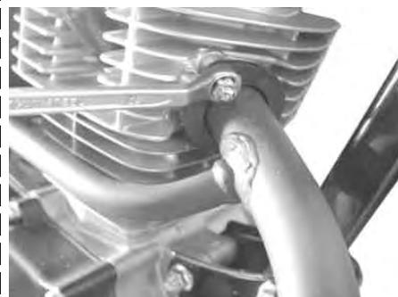
インレットパイプ部に取り付けているフィードパイプステーをキット内のステーに取り付け変えます。
