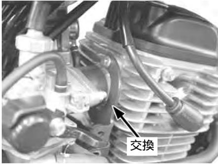
インレットパイプガスケットが損傷しない様、キャブレターを手で押させながら慎重に作業を行い規定トルクまでインレットパイプのボルト2本を締め付けます。
