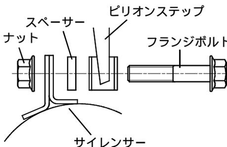
フランジボルト2本を規定トルクまで締め付けます。
