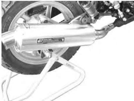
ピリオンステップのマフラーステー部に、キット内のスペーサー、フランジボルトを用いてサイレンサーを図を参考に取り付けます。
