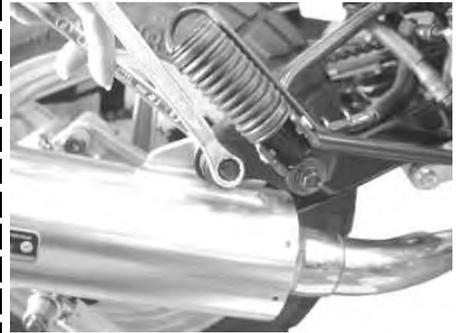
サイレンサー部のネームプレート及び認証プレートの保護フィルムを剥がします。
