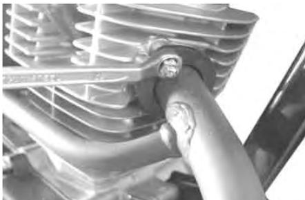
フィードパイプステー部のボルトを規定トルクまで締め付けます。
