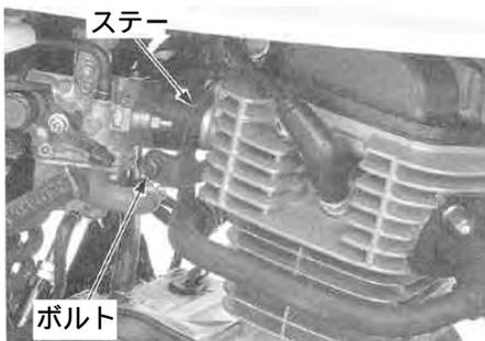
エキゾーストパイプフランジ部のナット2個を均等に規定トルクまで締め付けます。
