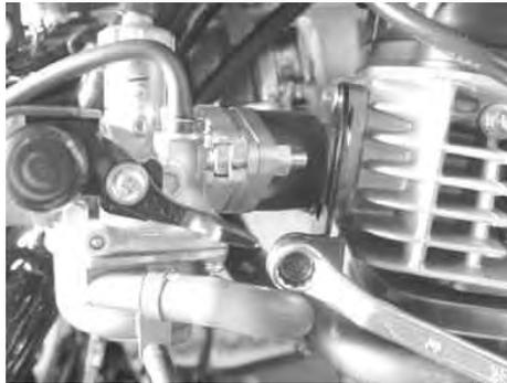
エキゾーストパイプ差し込み部に耐熱ガスケット材をうすく塗布します。
