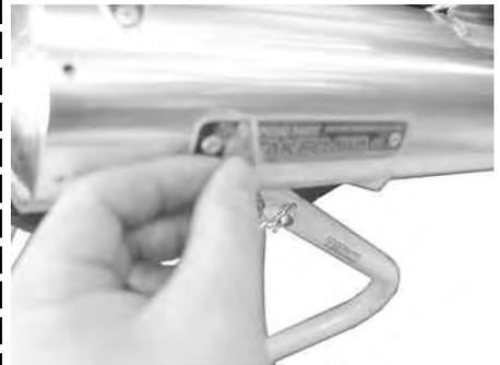
マフラーに付着した汚れをよく拭きとります。エンジンを始動させ、排気漏れの有無を確認します。
