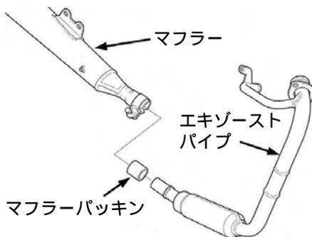
エキゾーストパイプのフィードパイプ部のステーを連結しているボルトを取り外します。
