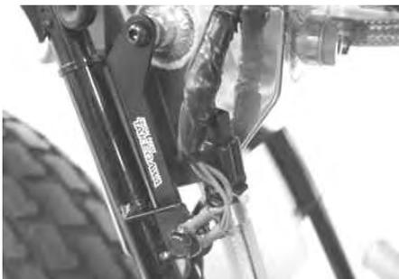
Lステ-をフレームL側のエアクリナーケース固定用ネジ穴の外側に ボタンヘッドスクリュー6×10にて仮止めし、Lステ-とキャッチタンクCOMPを ボタンヘッドスクリュー6×10にて仮止めします。
