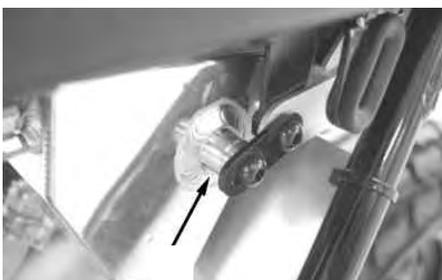
クランクケースへのリターンがスムーズになるよう キャッチタンクCOMPの角度を調整し、仮止めした ボタンヘッドスクリュー6×10 フランジボルト6×16を締め付けします。
