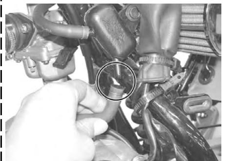
4. キャッチタンクCOMPのクラッチカバーブリーザー用ユニオンに ブレードホース12mm、ブローバイ排出用ユニオンに ブレードホース8mm、クランクケースブリーザー用ユニオンに チューブ5mmを差し込みます。ブレードホース12mmには ホースクランプ 15.5、ブレードホース8mmには ホースクランプ 13.1、チューブ5mmには ホースクランプ 9.5を使用し、各ホースを固定して下さい。
