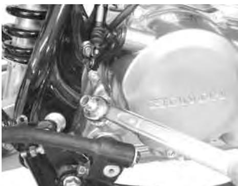
7. クラッチカバー用ブレードホース12mmを ブリーザーキャップに差し込み、ホースクランプ 15.5にて固定します。
