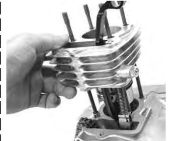
シリンダーにピストンリングの合い口がずれないように指で少しずつはめていきます。
