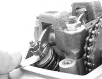
引き抜くときに少し抵抗があるぐらいにアジャストスクリューを合わせ、ナットを締め付けます。
