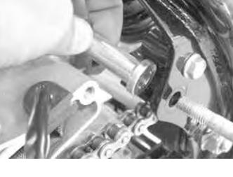
下側のボルトを抜き取り、エンジンをフレームの左側から取り外します。フレーム等に傷をつけないように注意して下さい。
