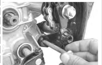
カラーとクラッチケーブルガイドを取り付け、リアエンジンマウントの上側にボルトを左側から差し込みます。
