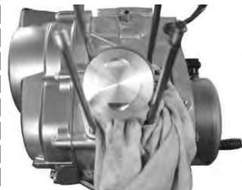
付属のピストンピンサークリップを取り付けます。
