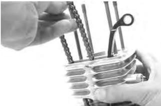
カムチェーンガイドの先端をクランクケースの溝に、突起部をシリンダーの溝に合わせるようにして差し込みます。
