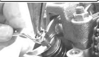
ナットを締め付け後、0.05mmのシクネスゲージを再度差し込み、バルブ隙間を確認します。
