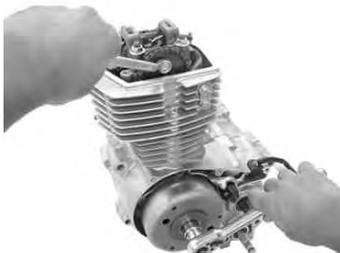
ロックボルトとセットプレートを取り外し、アジャスターを取り外します。
