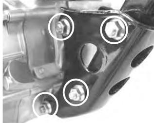
リアエンジンマウントの上側のナットを取り外します。
