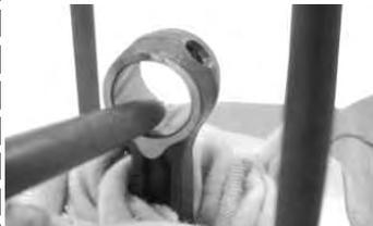
ピストンにエンジンオイルを塗布し、ピストンの上面の が、前(排気側)を向くようにピストンを取り付けます。
