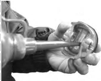
コンロッドのピストンピン穴にエンジンオイルを塗布します。
