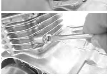
マイナスドライバーでアジャストボルトを固定し、ロックナットを締め付けます。
