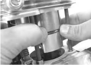
ピストンがシリンダーにはまったら、カムチェーンをシリンダーに通してシリンダーをクランクケースにはめ込みます。
