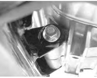
まず、上側のボルトを抜き取り、カラー(Apeの場合)とクラッチケーブルガイドを取り外します。
