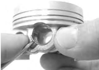
図を参考にしてピストンリングを取り付けます。
