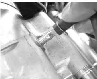
リフターレバーにクラッチケーブルを取り付け、クラッチケーブルガイドに取り付けてナットを締め付けます。
