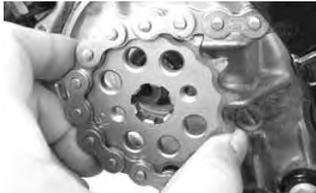
ドライブチェーンに適度なたるみを持たせたまま、仮止めしたリアエンジンマウントのナット2個と、フロントエンジンハンガープレートにナット4個を本締めします。
