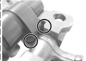
キットのカムシャフトのジャーナル面とカム面にエンジンオイルを塗布し、シリンダーヘッドに取り付けます。カムシャフトのカム山は下側に向けておきます。
