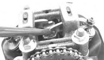
シリンダーヘッドカバーとガスケットをシリンダーヘッドカバーボルト2本でシリンダーヘッドに取り付けます。
