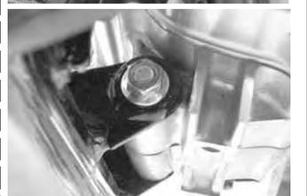
フロントエンジンハンガーを取り付け、ボルト4本を左側から差し込み、ナット4個を仮止めします。
