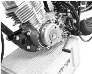
フロントエンジンハンガーのナット4個を取り外し、ボルト4本を抜き取ってフロントエンジンハンガーを取り外します。
