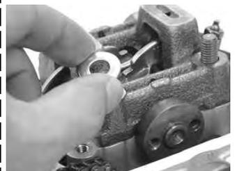
ナット 4個を対角に数回に分けて均等に締め付けます。
