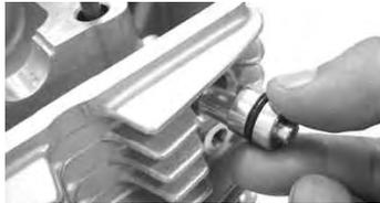
ロックボルトでセットプレートを仮止めします。
