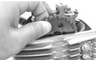
フライホイールを少し回して、カムスプロケットを回し、六角ボルトを取り付けやすくします。
