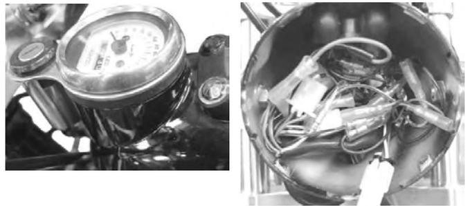
12. ヘッドライトケース内の配線類をヘッドライトユニットが入りやすい様にセットし、ヘッドライトレンズのTOPマークを上向きにセットし、ヘッドライトソケットにコネクタを接続してヘッドライトユニットをスクリュー 2 本にて取り付けして下さい。
