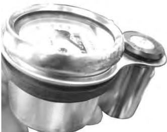
11. 取り外しの逆手順にて、スピードメーターを取り付け、コネクタを接続し配線類をヘッドライトケース内に収めます。
