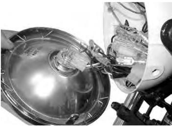
2. ヘッドライトケース内のメインスイッチのコネクタ及びスピードメーターの端子、ケーブルを外し、ヘッドライトケースから配線類を抜き出します。
