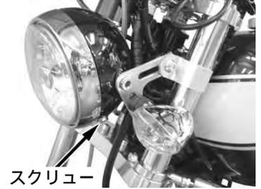
14. 風通しのよい場所でエンジンを始動し、ヘッドライトがHi/Low共に正常に作動するかを確認します。正常に作動しない場合は、バルブ切れやコードの接続不良等が考えられますので再度確認して下さい。
