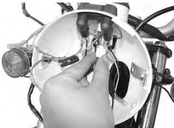
3. ヘッドライトケース横のボルト2本を緩め、ヘッドライトケースを取り外します。
