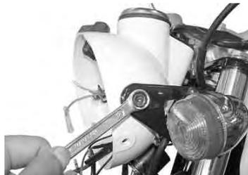
4. トップブリッジ裏のハンドルホルダを固定してあるナット、ワッシャを外し、ハンドルを取り外します。
