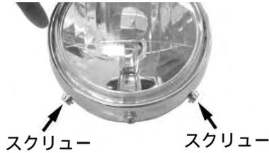
ハロゲンバルブは指で直接ガラス部分を触らないで下さい。熱により、バルブ切れの原因となります。触った場合はアルコールで拭き取って下さい。
