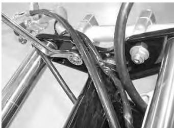
9. ヘッドライトケース下側スクリュー 2本を緩め、ヘッドライトユニットとケースを分割し、ヘッドライトユニットにハロゲンバルブをセットします。
