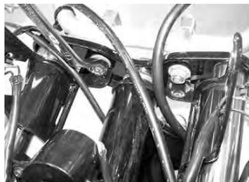
5. フロントフォークボルト及びステアリングステムナットを緩め、トップブリッジ及びヘッドライトブラケットを取り外します。
