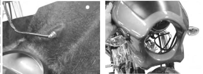
12. 取り付けが完了すれば、キット付属のフランジボタンヘッドスクリーでピキニカウルを固定します。
