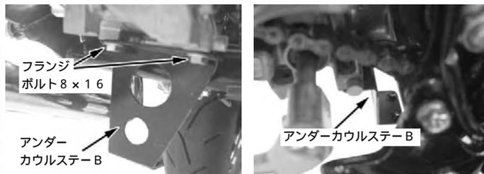
4. アンダーカウルをフランジボタンヘッドソケットスクリュー6×12を使用し、取り付けます。
