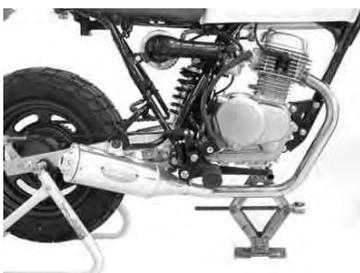
2. 矢印のマウントボルト2本を取り外し、アンダーカウルステーAを取り付けます。
