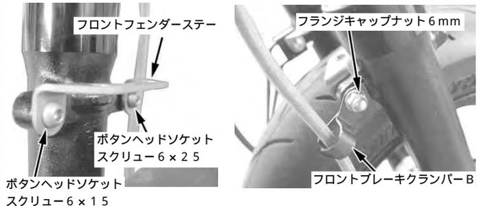
4. フロントフェンダーをタイヤに被せ、フランジボタンヘッドソケットキャップスクリュー6×16を用いてステーに取り付けます。
