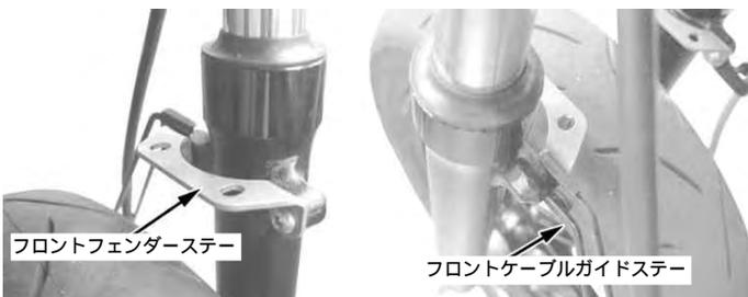
3. 右のフロントフォークには、写真の指示の様にステーとボタンヘッドソケットスクリューを取り付けます。
