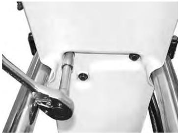
2. 左のフロントフォークにフロントケーブルガイドステーを挟み、フロントフェンダーステーをボタンヘッドソケットスクリュー6×15を使用して取り付けます。
