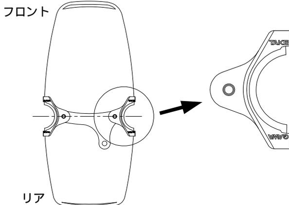
4. フロントフェンダーを絞る様に変形させながら、ステム側からアウターチューブ間にはめ込みます。
