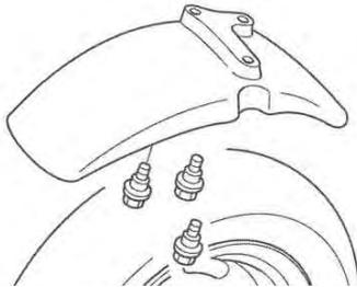
3. 取り外したフランジボルトを2本使用し、フロントフェンダー（純正）とフェンダーステーのフェンダー側だけしっかりと固定します。フェンダーに対してステーが垂直になるようにして下さい。
