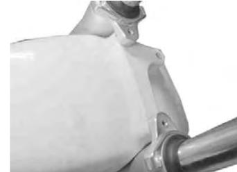
5. タイヤとの干渉を見ながら高さを調整し、写真の位置を参考にホルダーをダストシールの下に固定して下さい。
