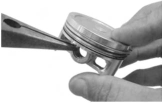
ピストンピンサークリップの合い口は切り欠き部を避けて取り付けること。
