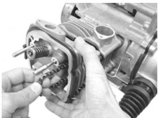
シリンダヘッドにノックピン2個を取り付け、カムシャフトホルダーを取り付ける。このとき、カムシャフトはカム山をシリンダヘッド側にして取り付ける。カムシャフトホルダーは“EX”の文字が下側(排気側)になるように取り付ける。
