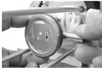
付属のピストンピンサークリップをもう片方のピン穴に取り付ける。
