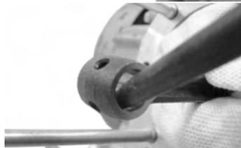
ピストン頂面の“ ”マークが、下(排気側)に向くようにピストンをコンロッドに取り付ける。
