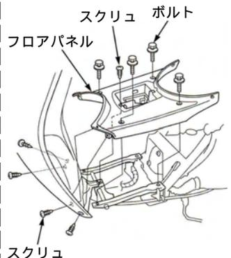
ワイヤーハーネス、ヒューズボックスをフロアパネルの穴に通し、フロアパネルを取り外す。
