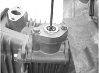
カムチェーンテンションの溝にOリングが付いているのを確認し、スクリューをカムチェーンテンションに取り付ける。
