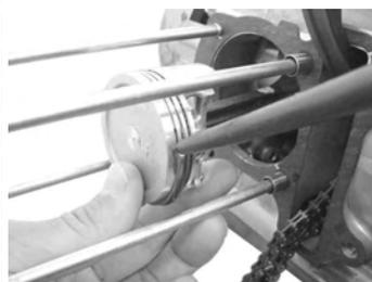
シリンダをピストンリングの合い口の位置がずれないように指で少しずつピストンにはめていき、シリンダをクランクケースにはめ込む。シリンダがピストンにはまったら、カムチェーンをシリンダに通しておく。
