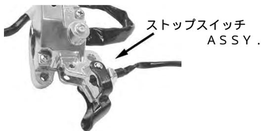
2. ウィンカースイッチから出ている黒、緑/黄のコードのギボシにストップスイッチの同じ色同士のギボシをそれぞれ接続します。
