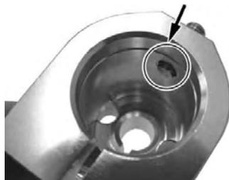
8. ハンドルポスト2をピンとステムシャフトの溝の位置を合わせて取り付けます。ピンを軽くねじ込んだ後、ロックカクナット6mmを使用してピンをロックします。ソケットキャップスクリュー10×3.5を取り付け、指定トルクで締め付けます。
