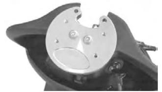
10. キット付属のハンドルパイプを仮付けして、ハンドル取り付け角度、スロットルハウジング、ウインカースイッチの取り付け位置を決定します。スロットルハウジング、ウインカースイッチのクランプ部には位置決め用の突起があります。取り付ける場合は、その突起を削り取るか、ハンドルパイプに穴を開けて下さい。取り付け位置の決定は慎重に行ってください。
