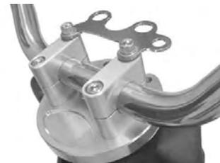
12. STDのハンドルパイプから取り外したスロットルハウジング、ハンドルグリップL等を取り付けます。スロットルケーブル、ブレーキホース及びブレーキケーブル等はハンドルポスト前部を通して取り回して下さい。
