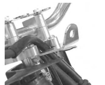
14. キット付属のスピードメーターをステーに固定します。取り付けは、ラバーマウントで取り付けますので図を参考に行なって下さい。
