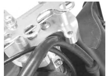
13. ヘッドライトステーをボタンヘッドスクリュー6×2.5、フランジUナット6mmを使用して取り付け、指定トルクで締め付けます。
