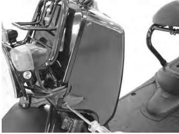
2. ウィンカー及びヘッドライトのコードを固定してあるフロントカバー付属のワイヤバンドを外し、ウィンカーコネクタとヘッドライトカプラの接続を外します。
