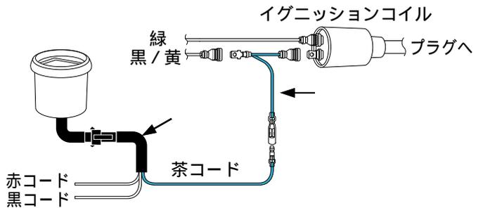
15. エンジンを始動し、メーターの照明が点灯するか確認して下さい。正常に点灯しない場合は、バルブ切れやコードの接続不良等が考えられますので再度確認をして下さい。
