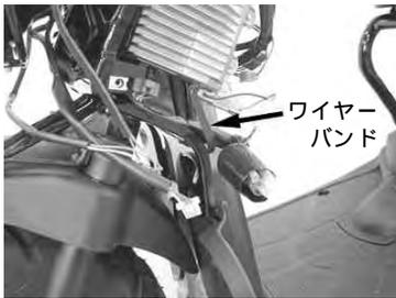
3. ヘッドライトブラケット固定ボルト3本と、フロントカバー固定スクリー2本を外し、ヘッドライトブラケット及びフロントカバーを取り外します。
