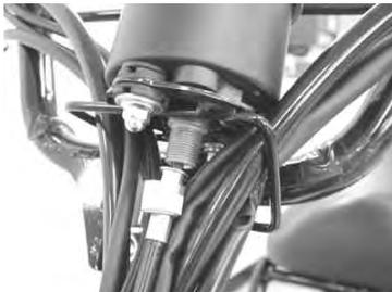
5. メーターコードを固定してあるワイヤバンドを緩め、メーターマウントナット2個を外し、メーターをハンドルから取り外します。
