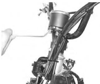
6. メーターステー上側の中央穴よりメーターASSY.のコードを通し、メーター取り付けボルトを2箇所穴に通します。
