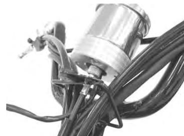
10. ハンドルのメータステーに(7)で組み立てたスピードメーターCOMP.を載せ、ソケットキャップスクリュー、ブレンワシヤの順で締め付けます。
