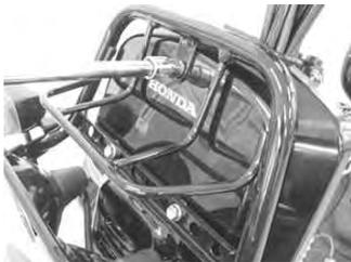
4. メーターの3P白カプラ及び黒色コードの接続を外し、メーターケーブルをメーターから外します。
