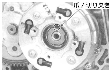
キットのクラッチアウトカバーにリフトベアリングとガスケットを取り付け、クラッチアウトにスクリー 4本で取り付けます。
