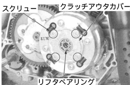
14mmロックワッシャの爪を起こします。クラッチアウトを保持し、ロックナットレンチを用いてロックナットを取り外します。
