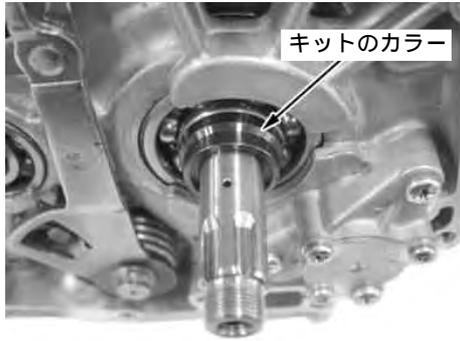
ノーマルのプライマリドライブギアをメインシャフトに取り付け、スナップリングを取り付けます。
