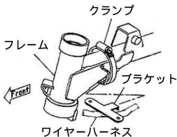
6. オイルクーラーブラケットにオイルクーラーCOMP をボタンヘッドスクリュー（6×10）スプリングワッシャ（6mm）とブレンワッシャ（6mm）で取り付け、締め付けます。（この時、ワイヤーハーネスがオイルクーラーブラケットとオイルクーラーの間を通るようにして下さい。）
