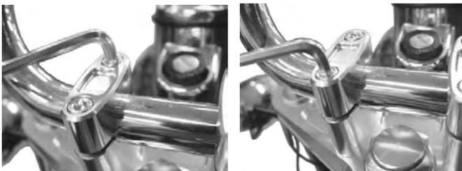
7. 取り付けしたステアリングハンドルに取り外したスロットル、レバー類等を取り付けます。
