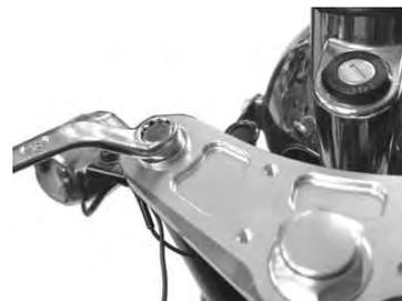
4. ステアリングステムナットを規定トルクで締め付けます。
