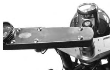
5. キット内のロウ - ハンドルホルダーのマークが入っている側を前方に向け取り付け、ステアリングハンドル、キット内のアッパーハンドルホルダーをキット内のソケットキャップスクリュー 6 × 5 5 を用いて取り付け、仮締めします。
