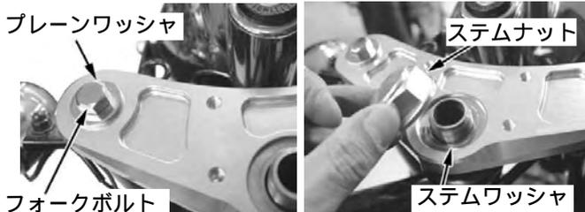
3. フォークトップボルトを規定トルクで締め付けます。
