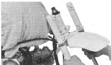
2. キット内のトップブリッジを取り付け、ノーマルのステムワッシャ、キット内のステアリングステムナット、ノーマルのプレーンワッシャ、フォークボルトを用いて仮付けします。
