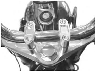
6. ハンドルの位置を決め、ハンドルホルダーの前方のボルトを規定トルクまで締め付けます。
