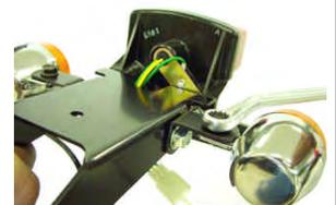
9 a . モンキー： テールブラケットの裏側に ワイヤークリップを フランジボルト、 六角ナットにて取り付けます。
