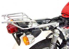
2. ツールボックスを取り付けてあるキャップナットを取り外し、ツールボックスを取り外します。
