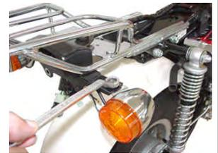
6. リアキャリアのマウントボルト4本を外し、配線を留めてあるワイヤークリップを緩め、リアキャリアを取り外します。
