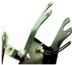
9 b . ゴリラ： テールブラケットの表側にウインカーリレーステー、裏側に ワイヤークリップを フランジボルト、 六角ナットにて取り付けます。この時ウインカーリレーステーを逆さまにしてウインカーリレーを付けてください。(図A参照)
