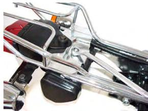
3. ウインカーリレーステーを取り付けてあるボルトを取り外し、ウインカーリレーステーをキャリアより外します。
