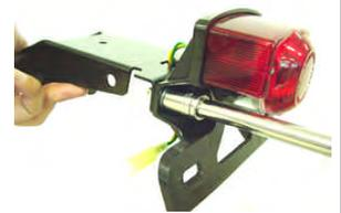
8. テールブラケットにウインカーステーをフランジボルト、六角ナットにて仮止めし、ウインカーをSTDボルトにてウインカーステーに取り付けます。
