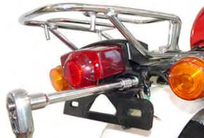
5. 左右ウインカーの配線を外し、テールライトブラケット裏の左右ウインカーの配線を留めてある爪を緩め、ウインカーを固定してあるボルトを外し、テールライトブラケットより左右ウインカーを取り外します。
