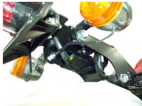
12 . ウインカーが地面に対し水平になるように(8)で仮止めしたボルトを固定します。
