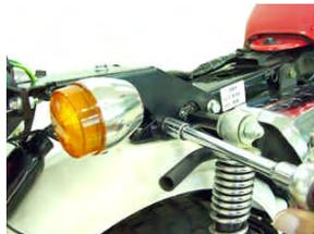
11 . 左右ウインカー及びテールライトの配線を接続し、接続部分にブーツを被せ、ワイヤークリップにて固定します。
