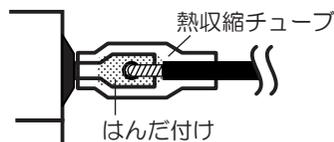
基本的な考えとして、回路上抵抗器がライトバルブの代わり電気を消費出来ればOKです。下図は配線の意味合を表したイメージ図で、装着場所が車体後方であれば、その周辺のワイヤーハーネスから配線を取り出す事も可能です。
