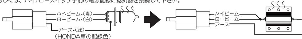
[取り付け例2 ～ヘッドライトの点灯/消灯が必要なレース車両～]
