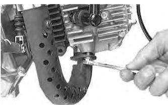
EXパイプ部のナット2個を反時計方向に回し取り外す。
