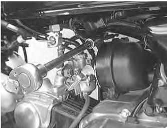
エアクリーナーステー部のボルトを反時計方向に回し取り外す。
