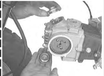
タレットキャップ2個を反時計方向に回し取り外す。
