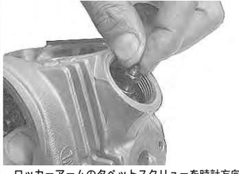
ロッカーアームのタペットスクリューを時計方向に回して取り付ける。
