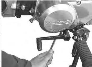
シフトベダルの六角ボルトを外しシフトベダルを反時計方向に回し取り外す。
