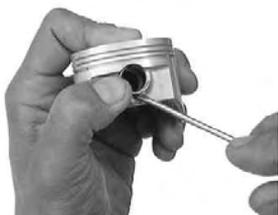
ピストンの片側に付属のピストンピンサークリップをサークリップ溝にきっちりはめ込む。この時、サークリップの合い口は切り欠き部を避けて取り付けして下さい。
