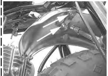
フロントフェンダー裏側の6角ボルト2本を締め取り付ける。
