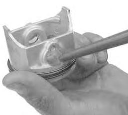
ピストンピン部とコンロッドにエンジンオイルを塗りピストンピンを取り付ける。
