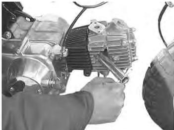
車載工具かプラグレンチを使いプラグを取り付ける。
