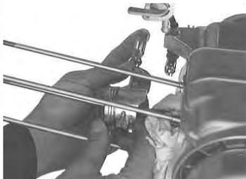
ピストンピンをピストンサークリップが付いている方向からマイナスドライバーで押してあげると簡単にとれます。
