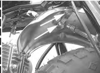
フロントフェンダー裏側の六角ボルト2本を反時計方向に回し取り外す。
