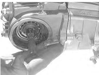
ヘッドサイドボルトを取り付ける。先に仮止めしていたガイドローラーボルトとシリンダーサイドボルトを締め付ける。
