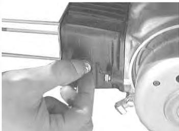
ゆるめておいたガイドローラーボルトとシリンダーサイドボルトを反時計方向に回し取り外す。
