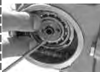
カムプロケットボルト穴をシリンダーヘッドの切り欠き方向に向けたときカム山がピストン側を向く様にかむシャフトをセットする。それがカムシャフトの圧縮上死点です。オプションカム取り付けの場合、オプションカムの説明書の指示に従って下さい。
