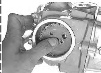
ここは難易度が高いです。がんばって下さい。チェンジペダルのシャフトの横にある6角ボルトを取り外す。カムチェーンを引っ張っているテンションナーがゆるむのではめやすくなります。カムプロケットをはめたあとはボルトを取り付ける。カムチェーンにカムプロケットをかけながらカムプロケットのOマークとシリンダーヘッドの切り欠き部が合う様にカムチェーンをはめてカムシャフトに取り付ける。
