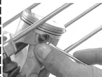
ドライバーでピストンにキズを付けないように押し込むと比較的簡単に取り付けられます。押し込み中にサークリップが外れて飛んでしまうことがあるので慎重に行ってください。目に入らぬように防護メガなどを着用して下さい。
