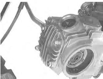
シリンダーヘッドカバーを止めているナット4個を対角の順番に反時計方向へ回し取り外す。ナット下にあるワッシャー4枚を取り外す。
