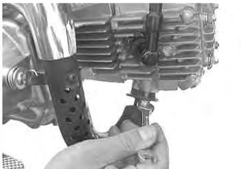
E×パイプ部のナット2個を締める。(仮止め)
