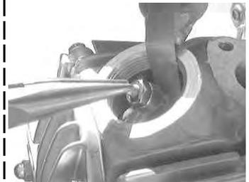
ロッカーアームのタペットスクリューを締め込んでいきタペットスクリューとバルブシステムエンドの間に0.05ミリのシックネスゲージを入れて少し抵抗があるくらいで引き抜ける様に合わせてタペットナットを締め付ける(少し抵抗があるというのがわからない場合0.07と0.03のシックネスゲージを用意して0.07がすき間に入らず0.03がゆるく入る様に合わせればだいたい0.05ミリということになる)IN・EX共に0.05ミリに合わせる。
