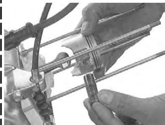
ピストンに三分の程度ピストンピンを挿入しておいて取り付けるのも簡単な方法ではある。付属のピストンピンサークリップをサークリップ溝にきっちりはめ込む。
