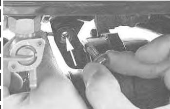
エアクリーナーステー部のボルトをアース線と共に締め取り付ける。
