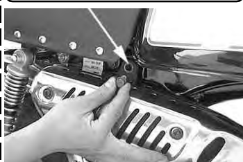
マフラー本体を止めている六角ボルトを取り付ける。(仮止め)
