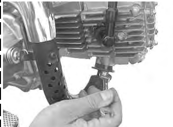
E Xパイプ部のナット2個を締める。(仮止め)
