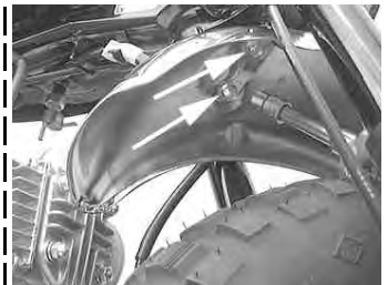
フロントフェンダー裏側の六角ボルト2本を締めて取り付ける。
