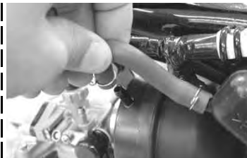
ストレージタンクのホース(フレームNO. AB 27-の車両)を取り付ける。
