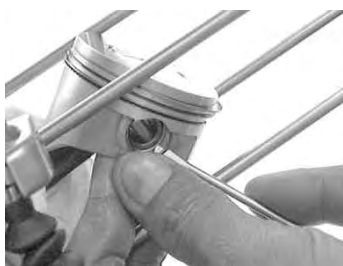
ピストンに三分の程度ピストンピンを挿入しておいて取り付けるのも簡単な方法ではある。
