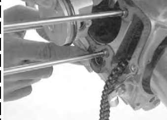
シリンダーガスケットとラバーパッキンを取り付ける。
