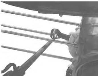
ピストンピン部とコンロッドにエンジンオイルを塗りピストンピンを取り付ける。
