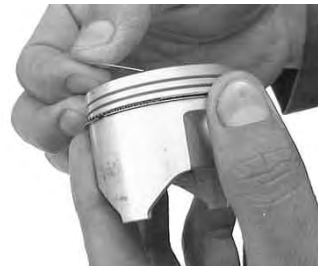
上オイルリングサイドレールを入れる。
