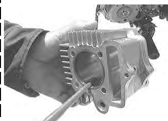
キットのシリンダー内にエンジンオイルを塗布し指で均等に塗り広げる。
