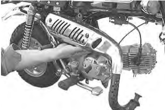
マフラーは、先にテールパイプをリアショックの内側を通しフランジ部分をシリンダーヘッドの排気出口付近まで持って行く。
