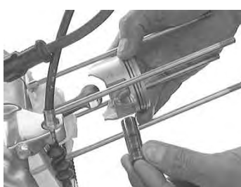
ピストンに三分の程度ピストンピンを挿入しておいて取り付けるのも簡単な方法ではある。
