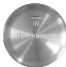
"IN"文字が上(インテーク側)になるようにピストンを取り付けます。
