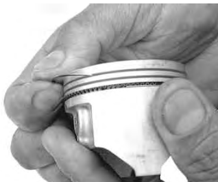
下オイルリングサイドレールを入れる。
