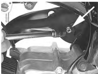
マフラー本体裏側に止まっているナットを反時計方向に回し取り外す。
