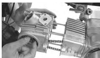
タイヤを手で押しながらシリンダーヘッドをスタットボルトに通す。シリンダーヘッドにカムチェーンを通しながら取り付ける。
