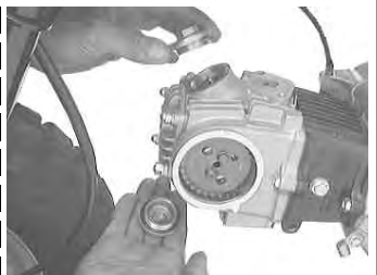
タペットキャップ 2 個を反時計方向に回し取り外す。
