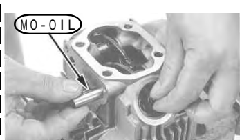
オリジナルのロッカーアームシャフトにモリブデン溶液を塗布し、ロッカーアームシャフトのネジ部を外側に向け、ロッカーアームとストッパープレートの穴位置を合わせ、ロッカーアームシャフトを取り付けます。
