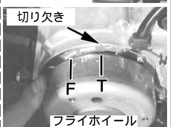
フライホイールの T マークとカムスプロケットの O マークが各切り欠きに合う様にフライホイールを反時計方向に回転させて合わせる。
