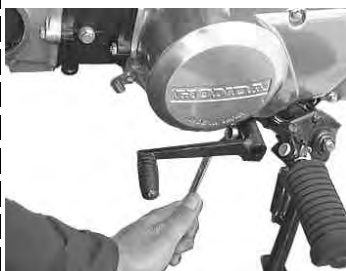
シフトペダルの 6 角ボルトを外しシフトペダルを反時計方向に回し取り外す。
