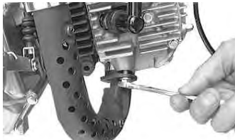
E Xパイプ部のナット 2 個を反時計方向に回し取り外す。
