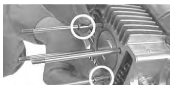
シリンダーにノックピン2個を取り付ける。
