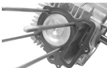
ヘッドガスケットを取り付ける。
