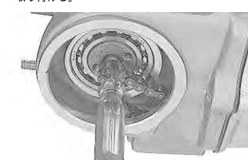
カムチェーンはシリンダーの方に落ちない様にカムシャフトの真ん中の穴にドライバー等を入れてカムチェーンを止めておく。
