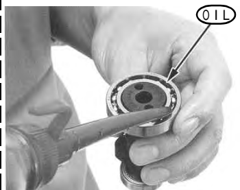
専用のカムシャフトの両端のベアリングにエンジンオイルを塗布します。
