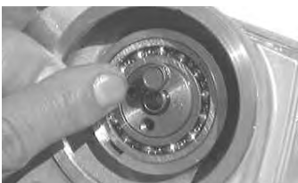
カムシャフトにカムスプロケットボルトを取り付け、引っ張るかプラスチックハンマーでヘッドを軽くたたくと抜けてくるので無理に引っ張らずカムシャフトを回しながら取り外す。
