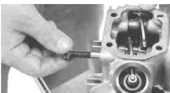
オリジナルのシリンダーヘッドのロッカーアームシャフトとロッカーアームのアジャストボルト及びアジャストナットを取り外します。
