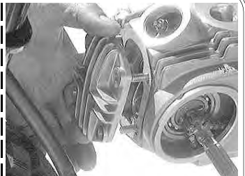
シリンダーヘッド面とシリンダー上面をシンナー等で脱脂する。
